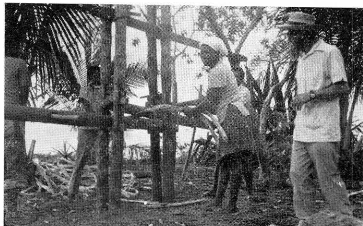
COREDÓ. — Tipo de trapiche rudimentario, completamente manual.
