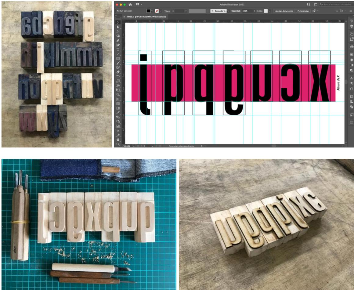
*Fig. 40. Pruebas de fabricación de tipos móviles en madera.*
