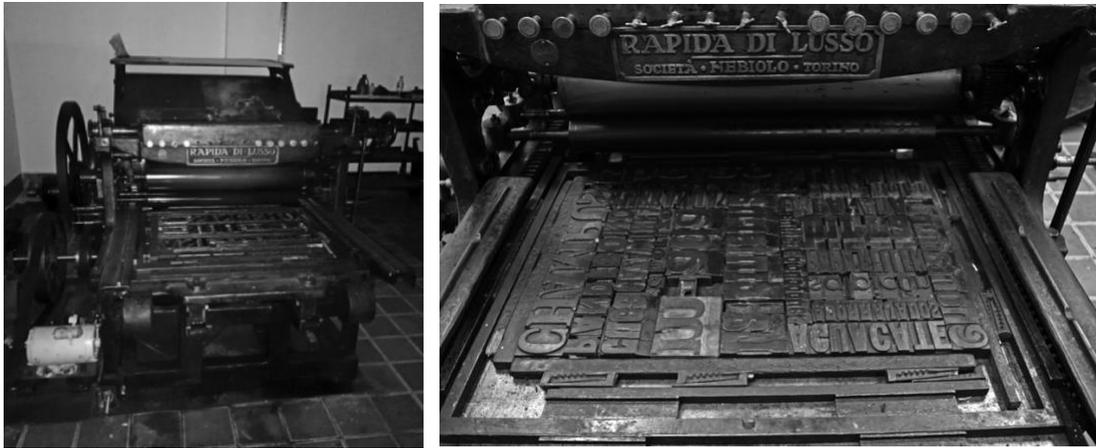
*Fig. 8. Prensa tipográfica Rapida di Lusso fabricada por Nebiolo en 1920.*
