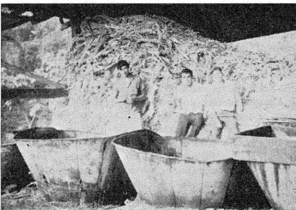
Parte del equipo de un trapiche: fondos y bagacera.
