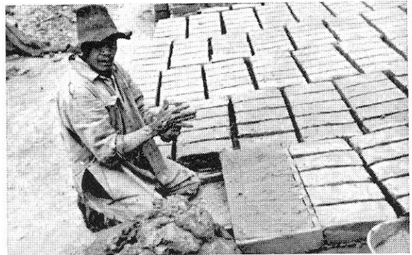
SOCHA. — Fabricación de ladrillo: el cortero echa el barro en la gavera y lo nivela con la mano.
